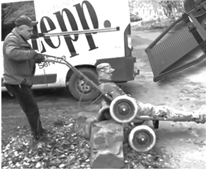
Евакуаційний візок може перевозити пораненого і долати на своєму шляху перешкоди до 50 сантиметрів.
