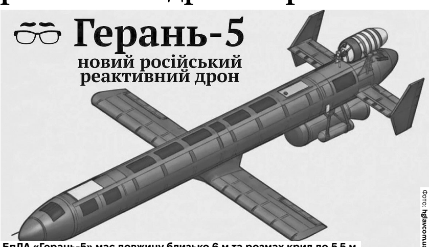
БПЛА «Герань-5» має довжину близько 6 м та розмах крил до 5,5 м.
